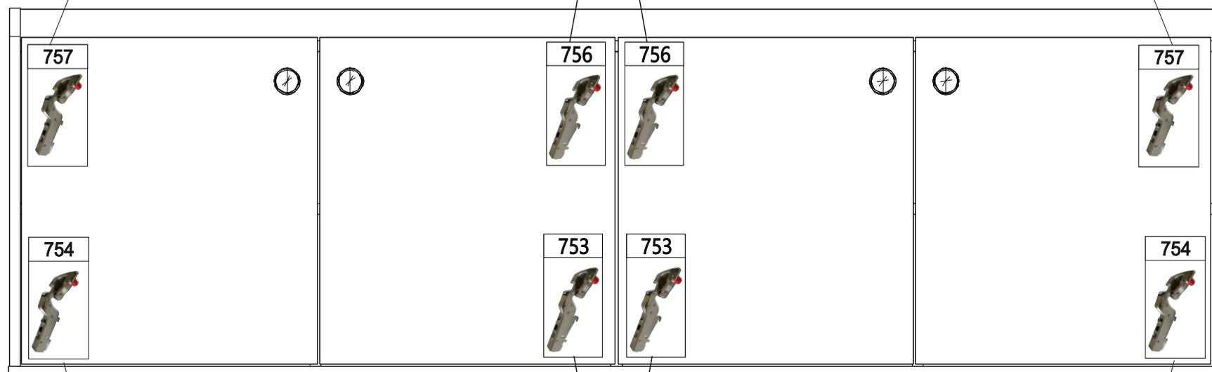
SCHARNIER MIT BREMSE Ø8 MM MIT DÜBEL 18
