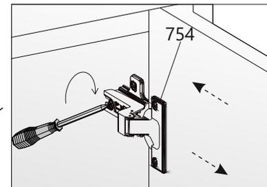
SCHARNIER MIT BREMSE Ø8 MM DÜBEL SDB
