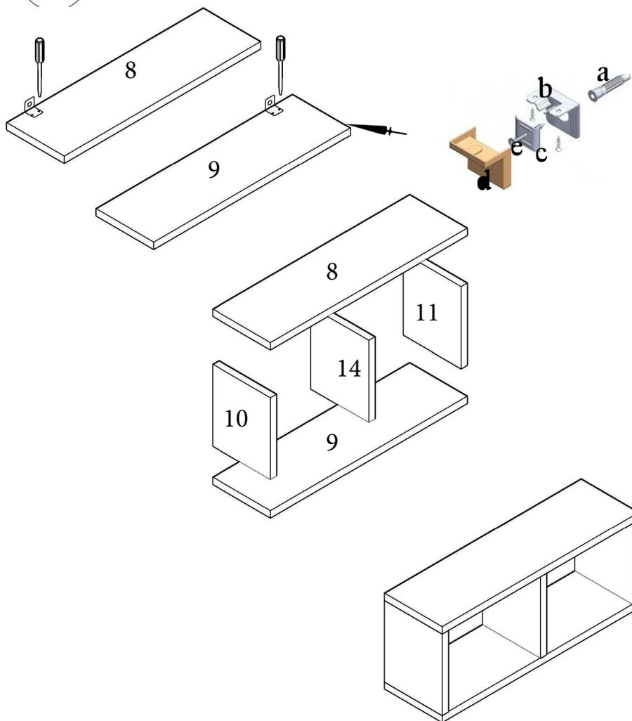
35\*18 Schrauben von den auf unseren Teilen 8 und 9 gezeigten Punkten. Montieren wir mit Hilfe von den Trägern unserer Aufhängungselemente.
