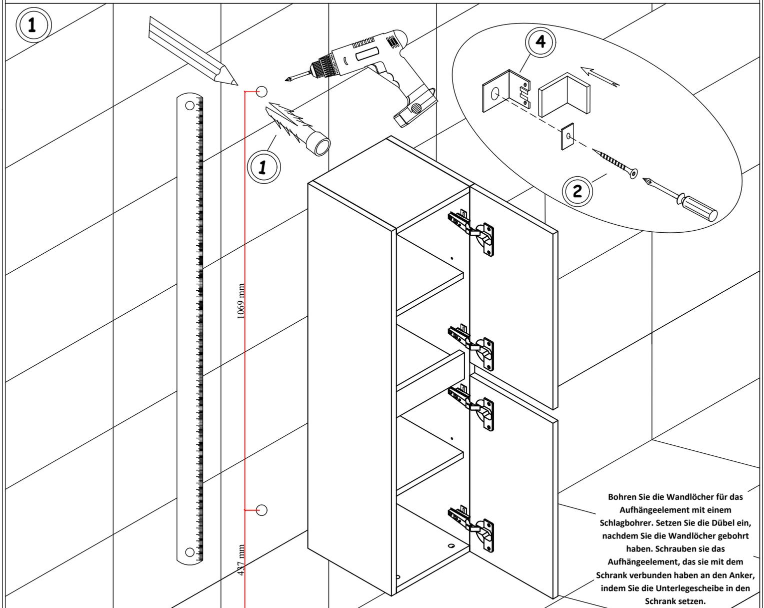
Bohren Sie die Wandlöcher für das Aufhängeelement mit einem Schlagbohrer. Setzen Sie die Dübel ein, nachdem Sie die Wandlöcher gebohrt haben. Schrauben sie das Aufhängeelement, das sie mit dem Schrank verbunden haben an den Anker, indem Sie die Unterlegescheibe in den Schrank setzen.
