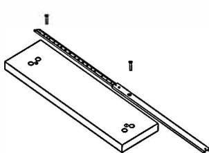
Schrauben Sie die Schubladenschienen (M), die aus dem Karton kommen, wie im Bild an den Beistelltisch (C) und wenden Sie den gleichen Vorgang an den anderen Teilen an.
