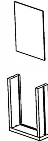
Setzen Sie den Boden der Schublade (G), die aus dem Karton kommt, in die Schublade wie im Bild ein und wenden Sie das gleiche Verfahren bei der anderen Schublade an.
