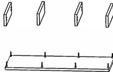
Befestigen Sie die Seitenplatten (C) wie im Bild am großen Tisch (B). Drehen Sie dann die Minifixe und ziehen Sie sie fest.
