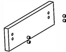
Befestigen Sie die Beistelltische (C) und Minifixe (J) wie in der Abbildung gezeigt. Machen Sie dasselbe mit den anderen Teilen.
