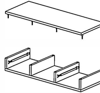
Platzieren Sie den großen Tisch (B) wie im Bild auf den Beistelltischen (C) und drehen Sie die Minifixe und ziehen Sie sie fest.
