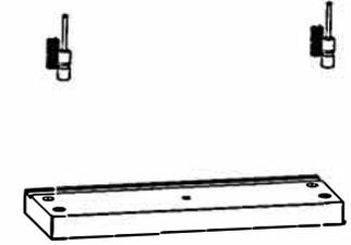
Befestigen Sie die Minifix-Schrauben (1) und die schwarzen Stifte (L) an der Vorderseite der Schublade (F), die aus der Verpackung kommt, wie in der Abbildung gezeigt. Machen Sie dasselbe mit den anderen Teilen.
