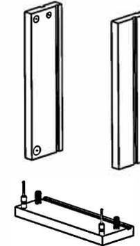
Befestigen Sie die aus dem Karton kommenden Schubladenseiten (D) wie im Bild an der Vorderseite der Schublade (F) und ziehen Sie die Minifixe fest. Machen Sie dasselbe für die andere Schublade.
